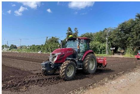
写真4 自動操舵システム搭載トラクター
