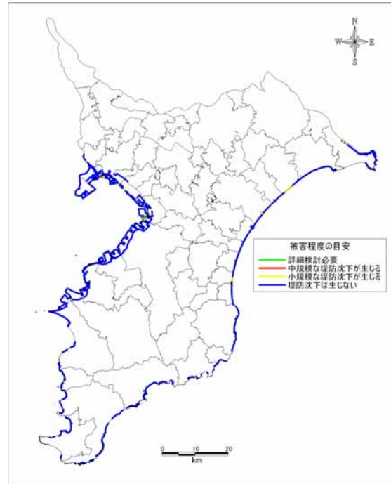
図 12.3-7 堤防被害程度分布図 (千葉県東方沖地震)
