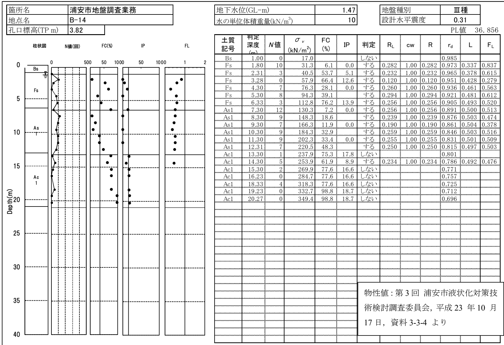
図-7.3.3(a) 道路橋示方書に準拠した液状化危険度試算結果（浦安市高洲小学校，地表加速度 300gal）
