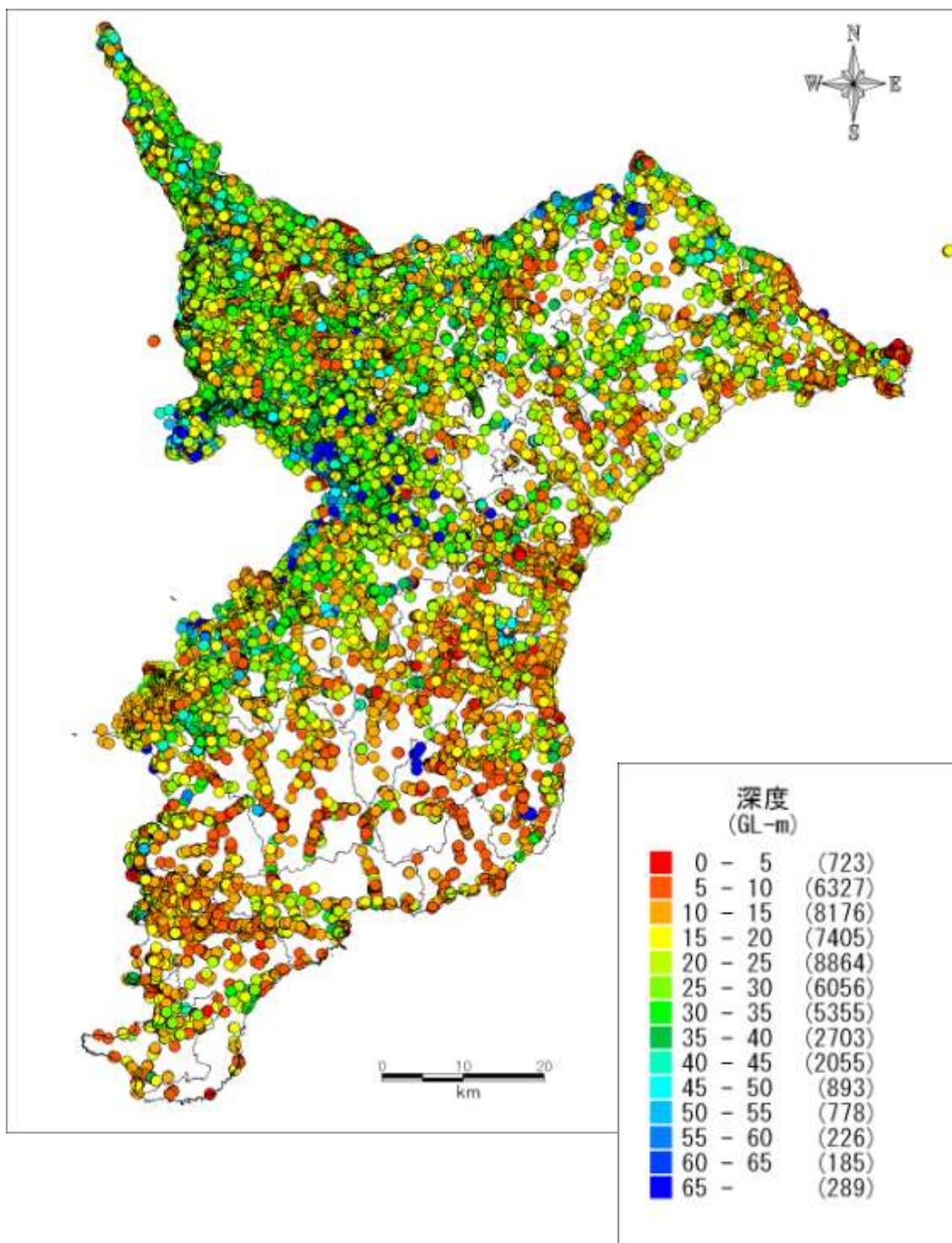
図 4.1-1 ボーリングデータ分布図（前回+新規収集分・50,035 本（重複データを除く））
