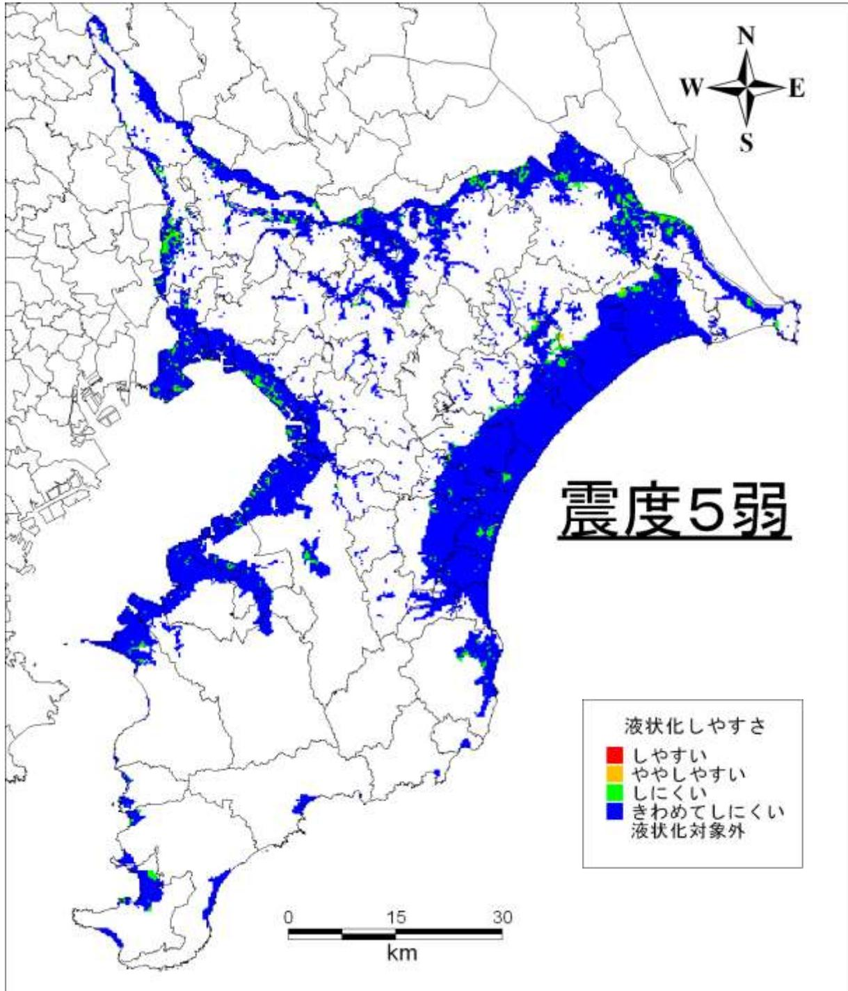
図 6.2-4(2) 液状化しやすさ試算結果
