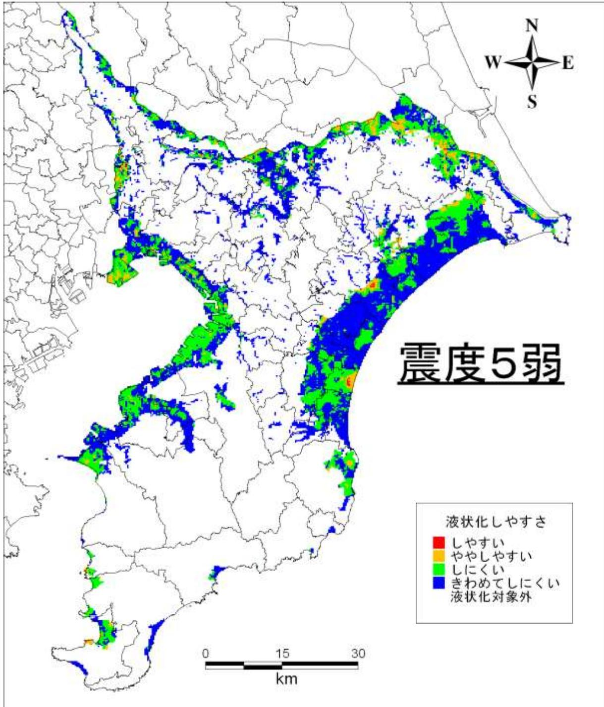
図 6.2-4(3) 液状化しやすさ試算結果
