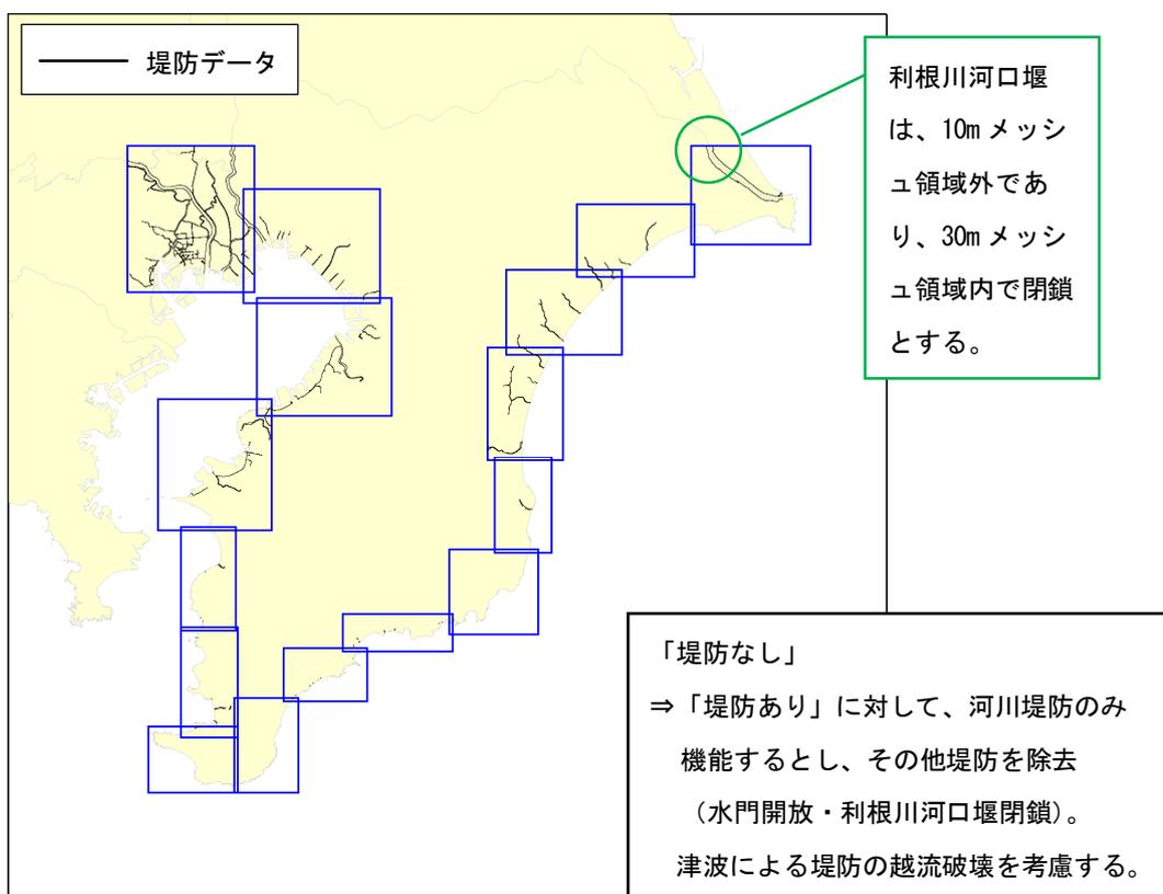
図 8-3 津波計算に使用した堤防データ
