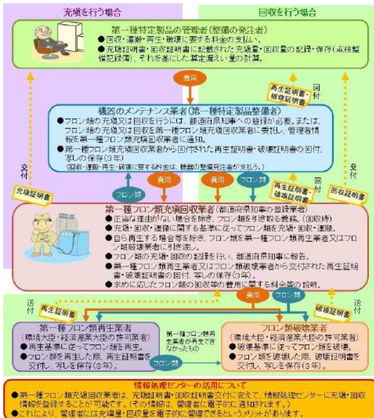
図 3 第一種特定製品の整備時におけるフロン類の充填及び回収の流れ
