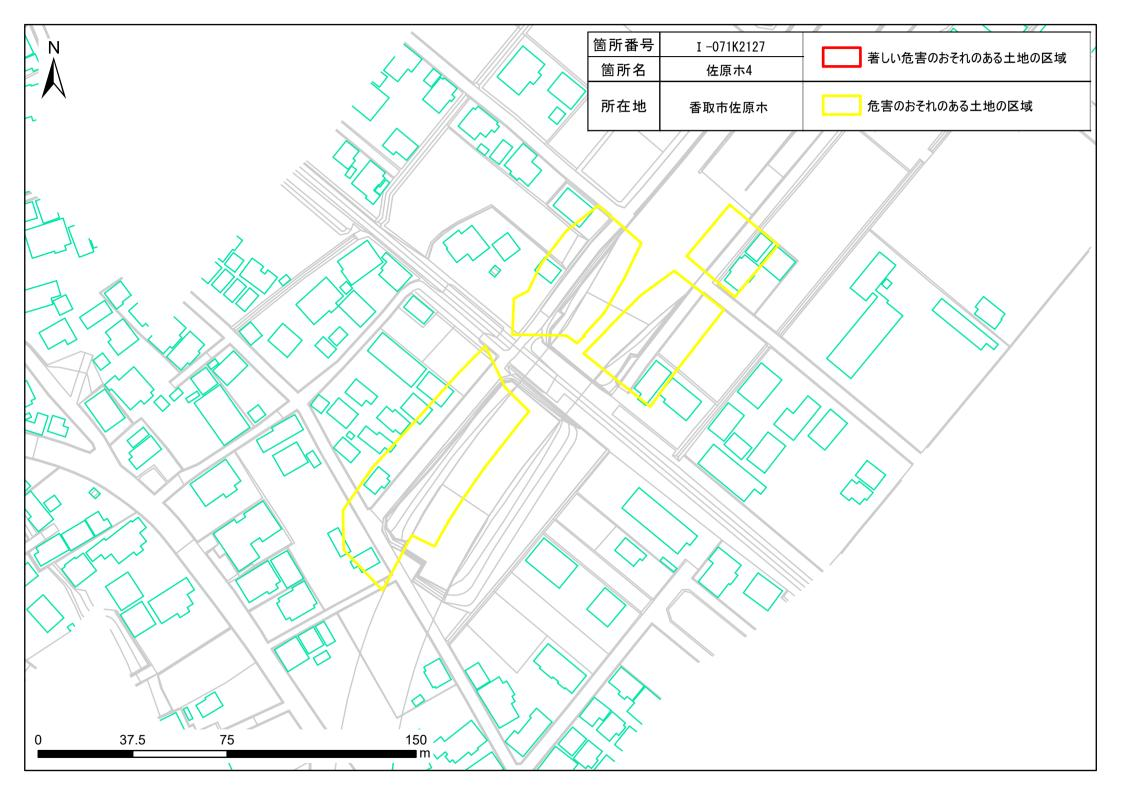
土砂災害警戒区域・特別警戒区域図(急傾斜地の崩壊)佐原ホ地区
