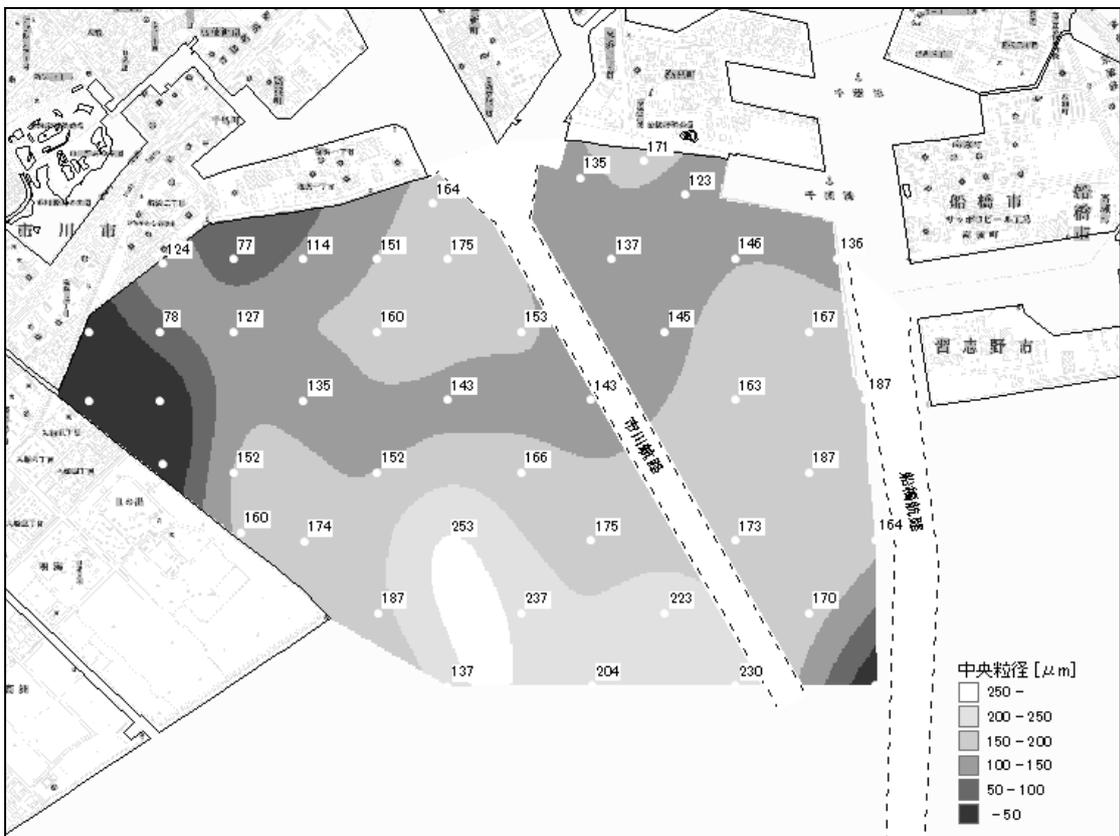
図 1.22(2) 夏季の中央粒径の水平分布(上:1996年度,下:2002年度)
