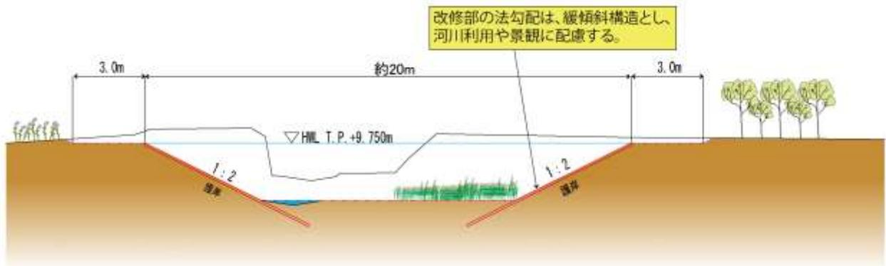
図 4.4 代表横断面図 岡田橋～不入斗川合流点 (NO. 39+25 地点)
