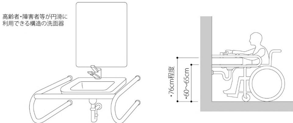
・構造的に可能であれば下部の空間の高さを68cm程度とると、大型車椅子の肘あて部分(高さ67cm程度)が下部空間に入るで使いやすい。
