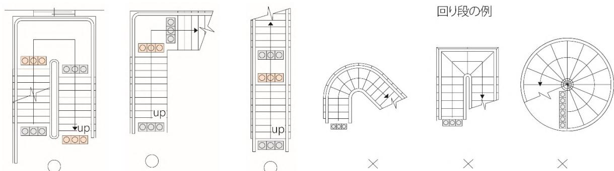
蹴上げ、踏面の形状（つまずきにくい構造の例） [図 3-3]
