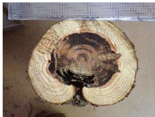
写真4 チャアナタケモドキ及びほかの木材腐朽菌に感染したスギの断面図
