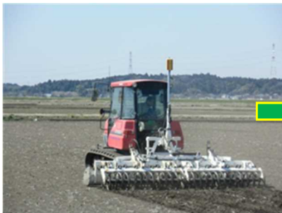
レーザー光を利用した均平作業
