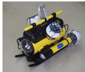
人工魚礁調査に使用するROV(水中テレビロボット)
