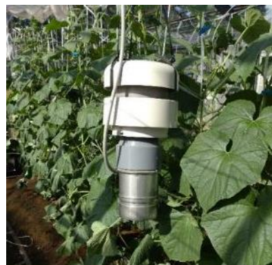
気温は通風筒を用いて正確に測定
