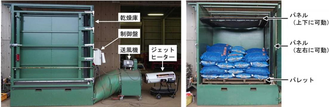
写真1 パレット対応乾燥装置
