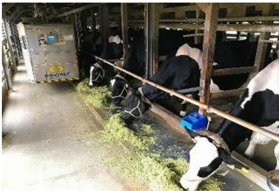
繋ぎ牛舎での自動給餌ロボットの導入
