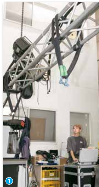
①操作盤で部材を吊り上げ
