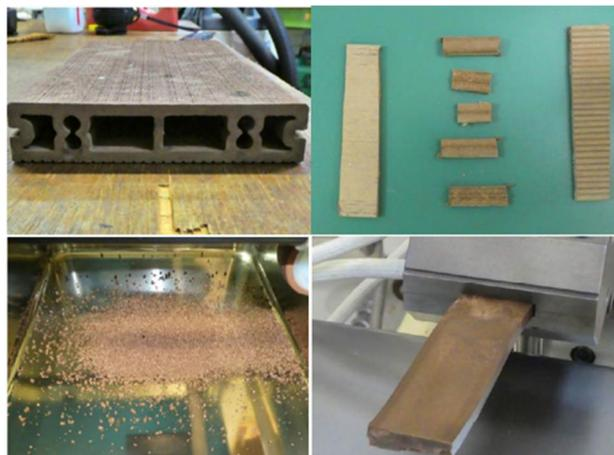
図2 ウッドデッキ試料の分割と再成形
