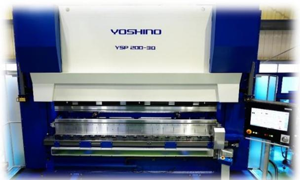
完全自動金型交換装置搭載 薄板板金曲げ加工機
