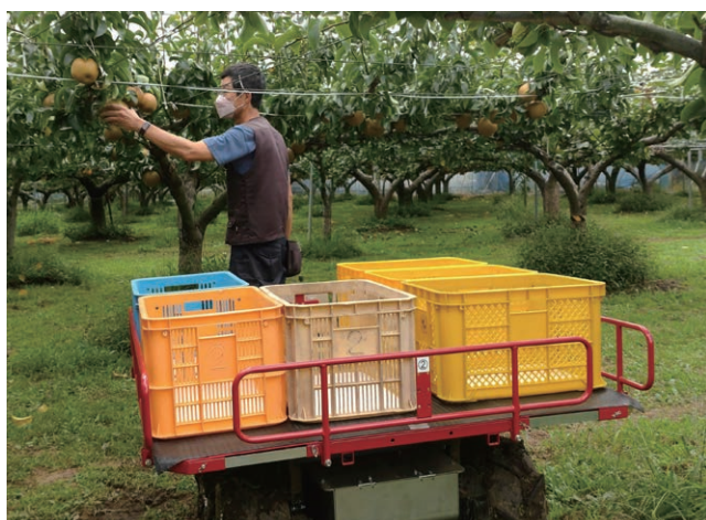
ロボット作業車による日本なしの収穫作業の省力化
