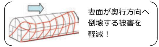
筋交い直管はパイプハウスを剛強に固め、妻面が桁行方向及び間口方向へ倒れるのを防止する役目を担っています(図-17)。筋交い直管の設置は、下図のように行い、直管の端は、しっかりと地中に埋め込むようにします。
