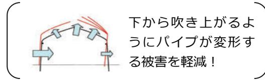
水田のあと地、整地して間もないところ、水はけが悪い土地など、基礎近くの地盤が緩んでいると、強風時にハウスに上方向に力が加かった場合に基礎が抜けやすくなります。スクリー杭を地中に埋め込んで、マイカー線などで上から固定することにより、引き抜き耐力を増加させることにより補強します（図-18）。
