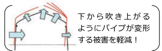
妻部に近い3スパン分（1.35m）と側面部の風当たりの強い部分には防風ネットなどを張ります。妻に近い部分は特に風を強く受けるため、防風ネット等を張ることによって被覆資材が破れにくくなります。さらに、防風ネットなどの上からスプリングで固定すると、より被覆資材が破れにくくなります（図-16）。
