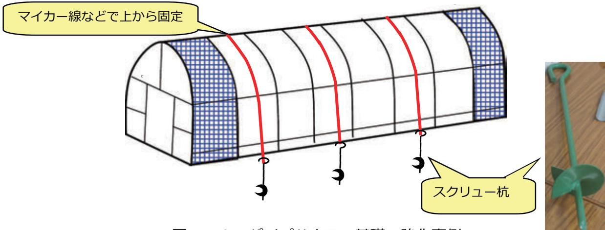
図-18 パイプハウスの基礎の強化事例
