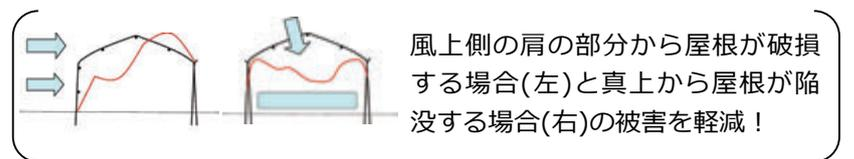
既存のハウスの内側にアーチ構造の骨材を組み込み補強します。地形の影響で風を強く受ける施設を重点的に補強します。パイプハウスの骨材が、二重のアーチ構造になることにより、非常に強度が高まります（図-19）。
