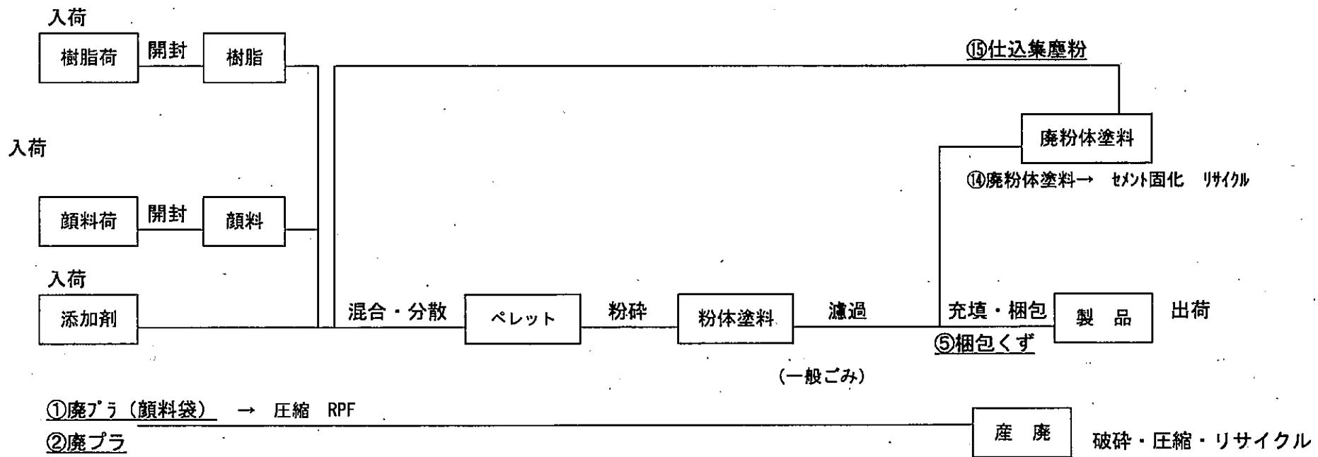
1. 作業の工程、製造品目ごとに工程図を作成し、各段階で発生する廃棄物（一般廃棄物を含む）を性状がわかるように具体的に記入すること。
