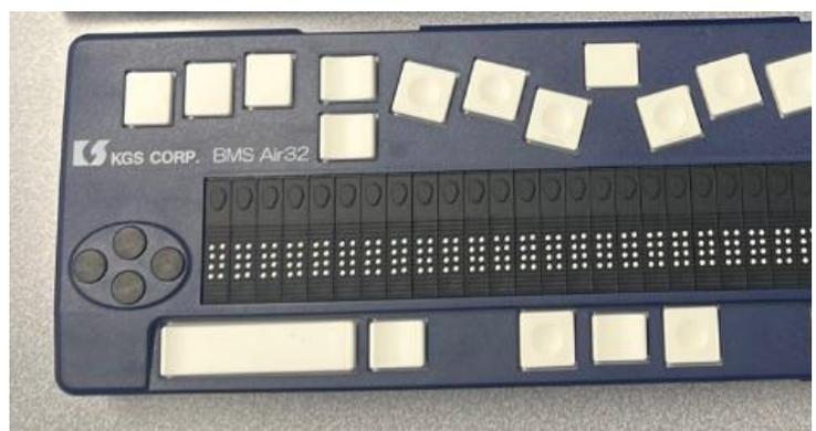
視覚障害のある県職員が利用している点字ディスプレイの例。手前に設けられた多数の点が持ち上がり点字を表現します。点字ディスプレイを利用すると、接続したパソコンの画面表示や保存したファイルの内容を点字で読むことができます。
