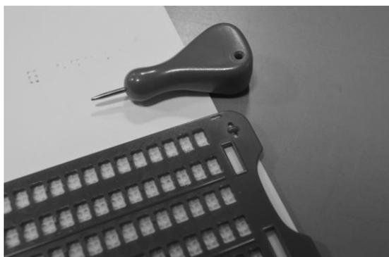
点字器の例。点字用紙を点字器ではさみ、点筆で打つことで点字を書いていきます。点字は裏側に浮き出るので、書くときは左右を反転させて作成します。
