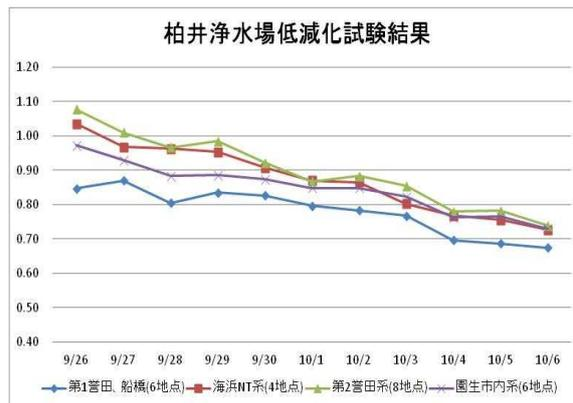
図4 柏井浄水場系残留塩素低減化試験
