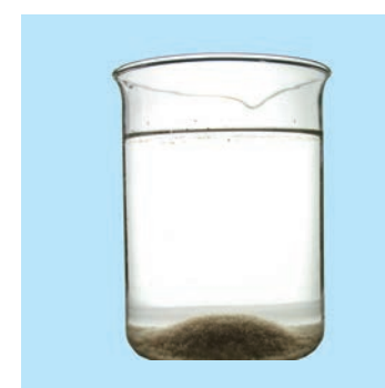
沈でん池ではにごりの固まり(フロク)を沈めて取り除く
