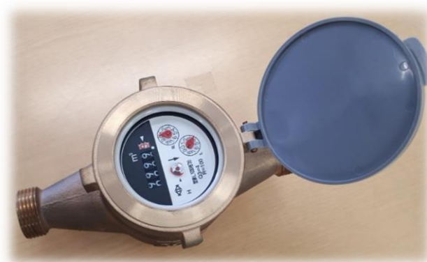
水道メーター
