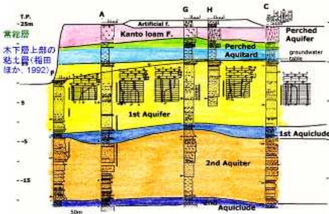
図1 調査地域の地質断面と透水層構造
