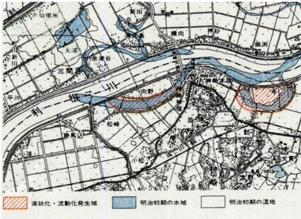
図1 利根川下流低地の明治初期の水域と1987年千葉県東方沖地震による液状化・流動化。(風岡他 2003, アーバンクボタ No.40)
