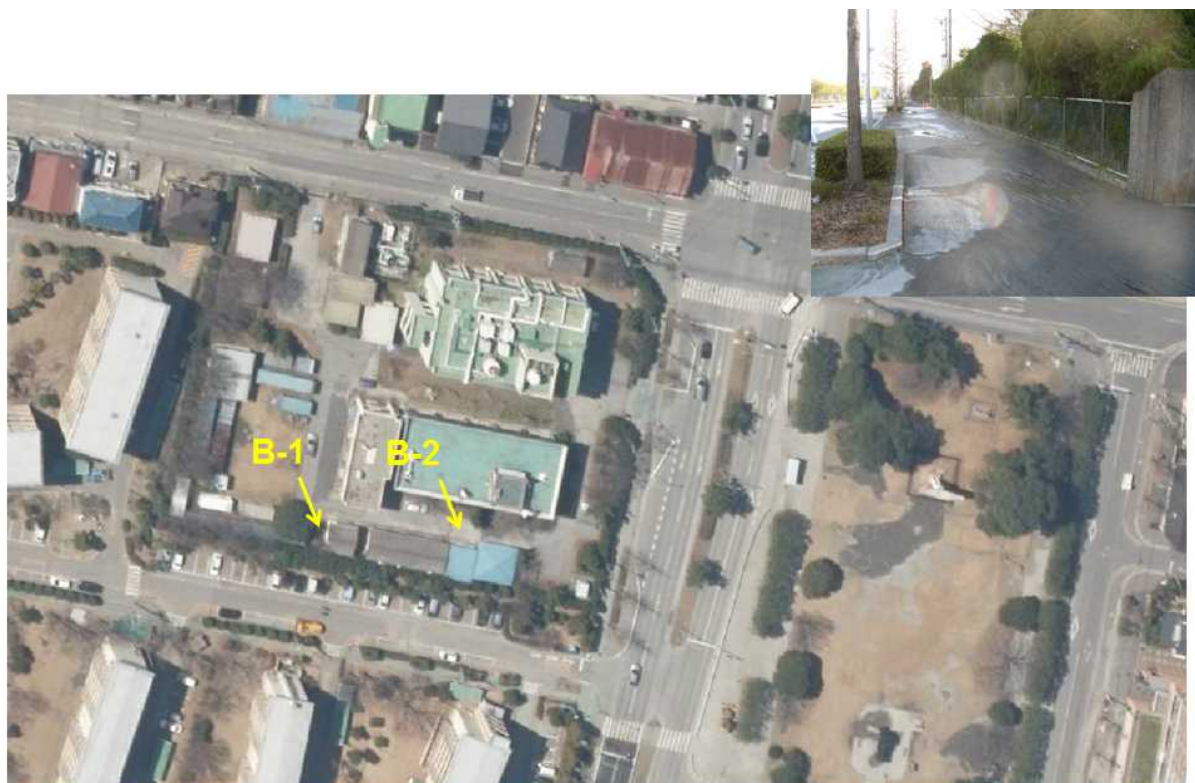
図1 千葉市美浜区稲毛海岸における噴砂状況と調査地点（航空写真は千葉県防災危機管理課によるもの）。
