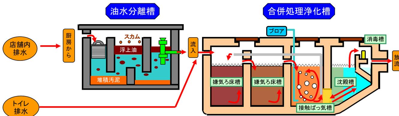
図1 排水処理のしくみ
