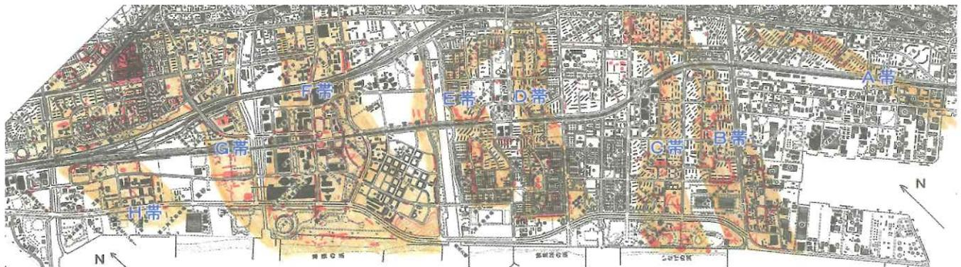
図4 船橋市～千葉市美浜区の液状化－流動化現象の分布 赤:液状化－流動化現象発生地 オレンジ:液状化－流動化現象集中帯
