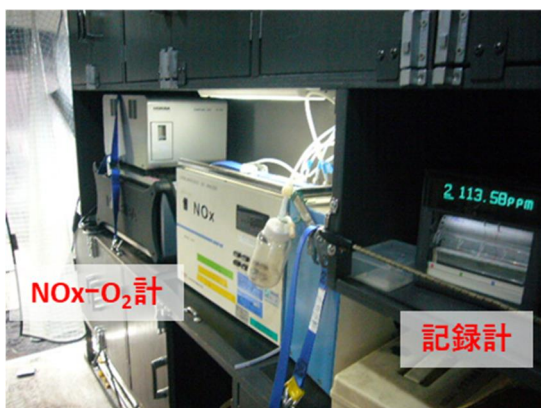
写真 3 ばい煙測定車内の主な測定機器 (2)
