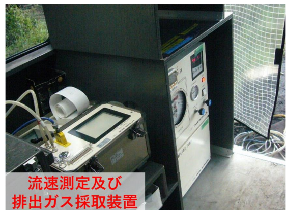
写真 2 ばい煙測定車内の主な測定機器 (1)
