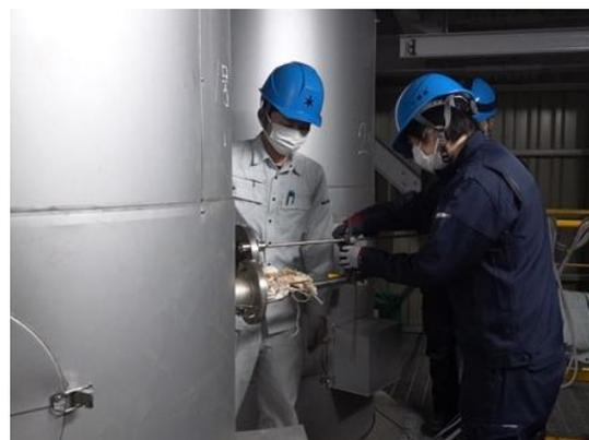
写真 4 煙道での測定の様子
