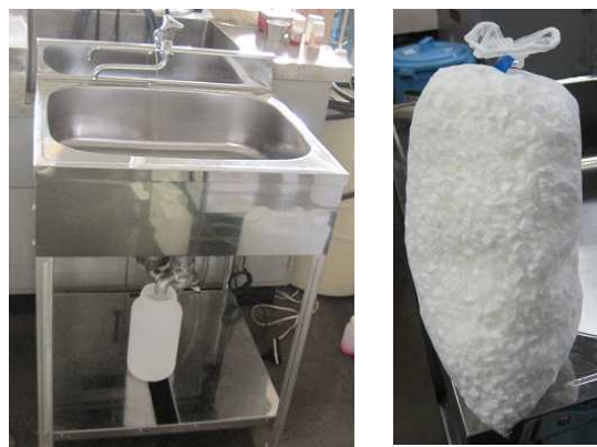
図３ シンク排水阻集器実験機（左） と阻集器内のフィルタ除去剤（右）
