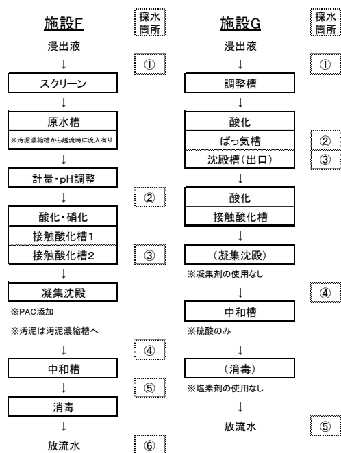
図 1 浸出水処理フロー及び採水位置
