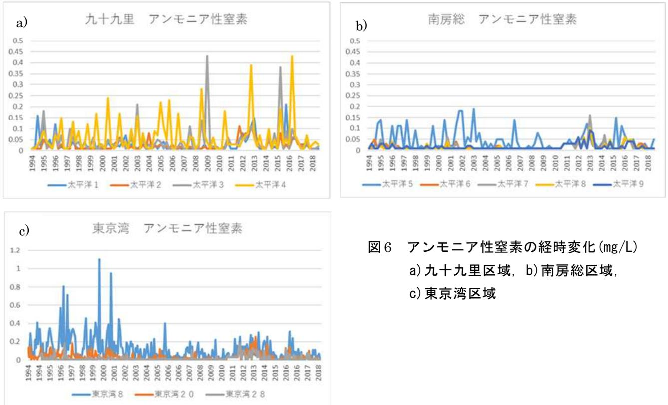
図6 アンモニア性窒素の経時変化(mg/L)
