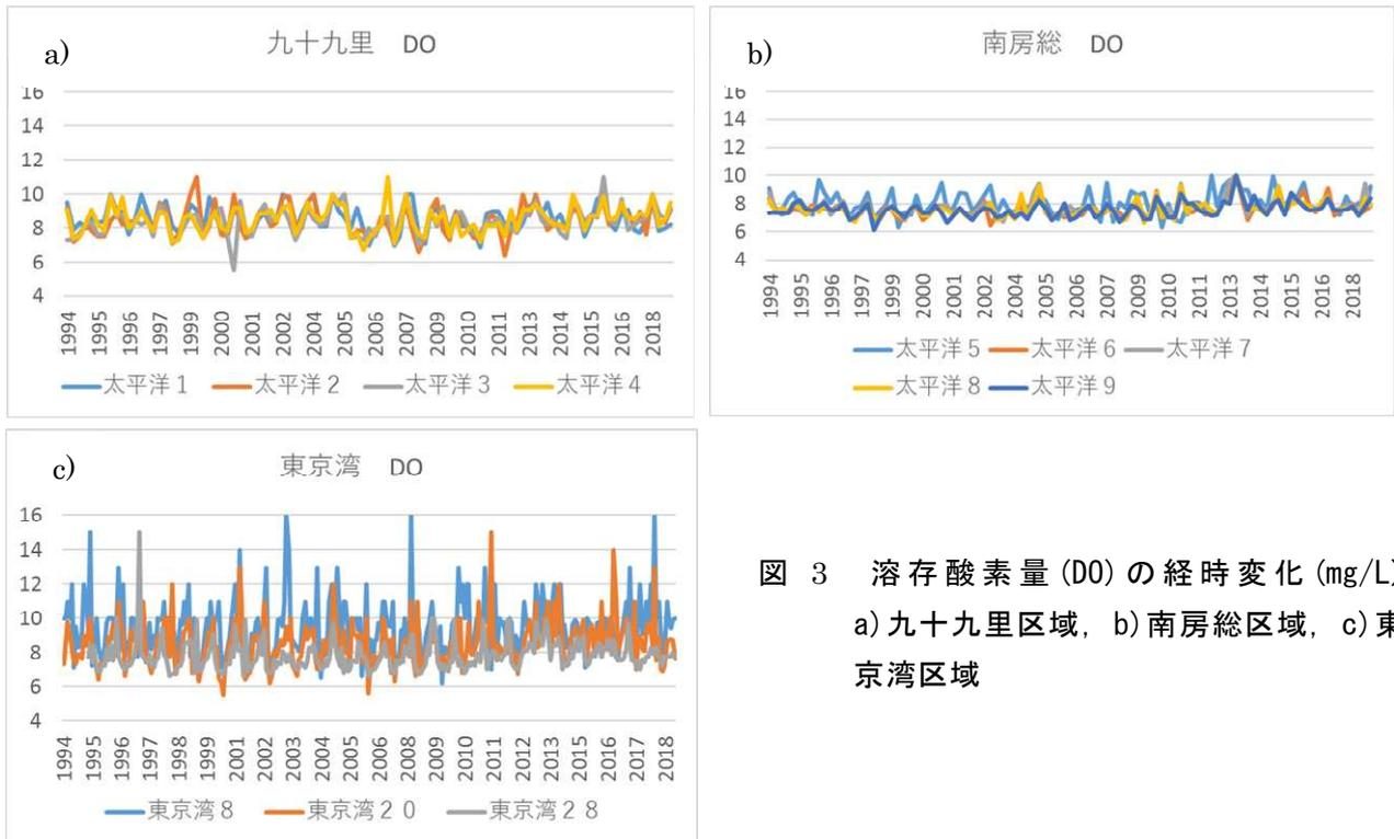
図 3 溶存酸素量 (DO) の経時変化 (mg/L)
