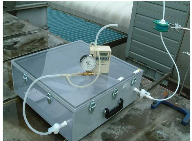
写真5 揮発性有機化合物採取用箱（採取袋入り）
