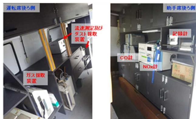
写真 2 ばい煙測定車内の様々な測定機器
