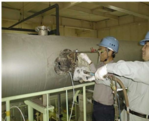
写真 3 煙道の測定の様子（ばい煙）
