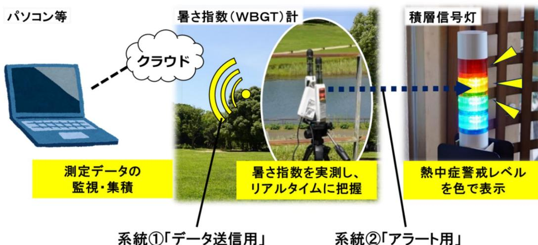
図6 設置した暑さ指数計及びその周辺機器の系統図
